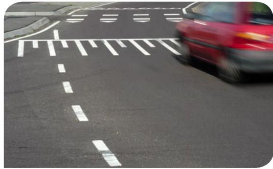
Taludstrepen bij verkeersdrempels geven een hoogteverschil aan.
